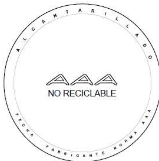
Figura 6. Rotulado tipo sistema aro – tapa de plástico reforzado (ALCANTARILLADO).
