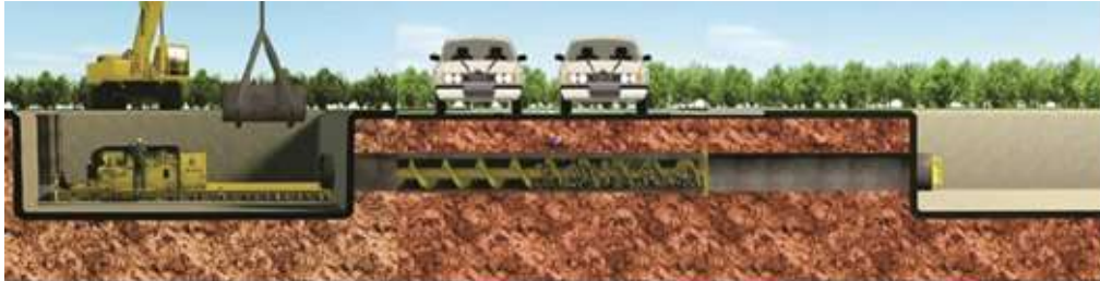
Figura 3.4.5.3.1 Esquema general de trazado y de excavación con cabezal giratorio.
