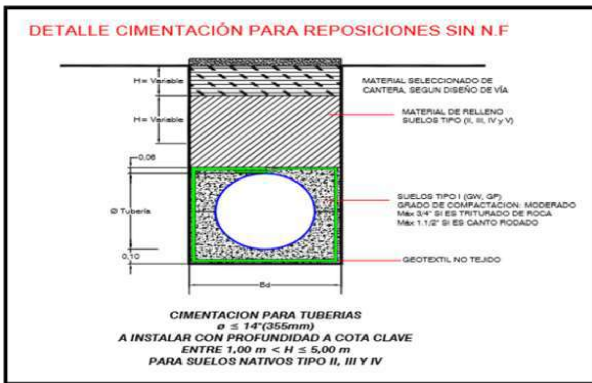
Figura 3.4.8.4. Tipo de Cimentación C
