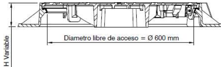
Figura 1a. Tipo de tapa con abertura mínima libre de 600mm (Sistema Aro – Tapa Hierro dúctil)
